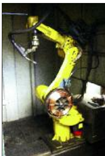
Un des nombreux robots de soudure de l'usine de Roche-Bettaincourt qui co-habite avec une ancienne mais efficace presse de 400 t
